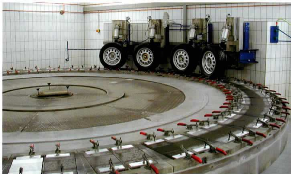
Das Foto zeigt die Rundlaufprüfanlage (RPA) der Bundesanstalt für Straßenwesen (BASt) in Bergisch-Gladbach. Auf diesem Verschleißsimulator werden neue Markierungssysteme einer Eignungsprüfung unterzogen.
