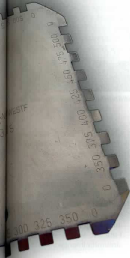
Das Foto zeigt einen Messkamm zur Bestimmung der Nassfilmdicke von Farben.
