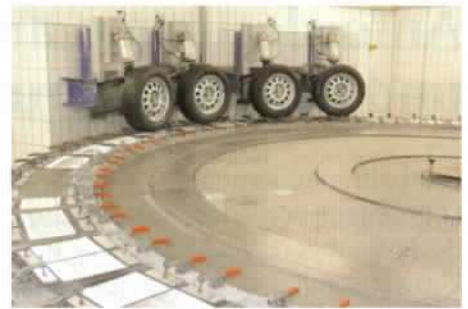
Das Foto zeigt einen Teil der Rundlaufprüfanlage bei der BAST
