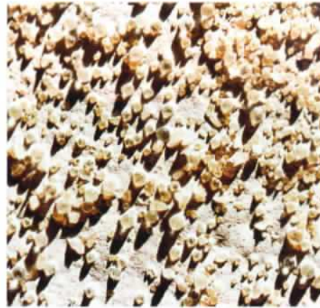
Die richtige Einbettung der nachgestreuten Reflexperlen ist bei diesen Systemen von großer Bedeutung.
