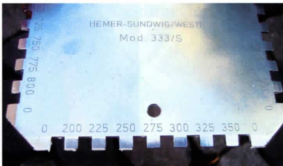
Der letzte gerade noch mit Farbe benetzte Zahn gibt die Nassfilmdicke wieder. Hier 0,25 mm
