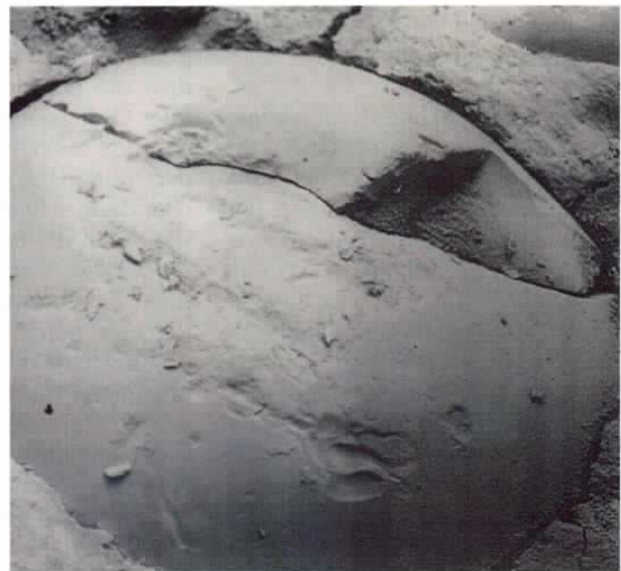
Die beiden Fotos zeigen sehr stark vergrößerte Teilausschnitte von unterschiedlichen Markierungsoberflächen. Auf dem rechten Foto sieht man eine noch fest im Markierungsstoff verankerte Glasperle, die durch mechanische Einwirkungen (z. B. Schneepflug) zerstört wurde. Wenn bei dieser Markierung die Reflektionswerte für die Nachtsichtbarkeit nicht mehr erreicht werden, liegt kein vom Auftragnehmer zu vertretender Mangel vor. Beim linken Foto hingegen fehlen bereits 3 Glasperlen komplett, während die 2 noch vorhandenen Perlen keine nennenswerten Beschädigungen aufweisen. Die fehlenden Perlen waren vermutlich nicht tief genug eingebettet oder konnten sich aufgrund einer falschen bzw. fehlenden Silanisierung nicht richtig mit dem Markierungsstoff verbinden. Es handelt sich also um einen vom Auftragnehmer zu verantwortenden Sachmangel.
