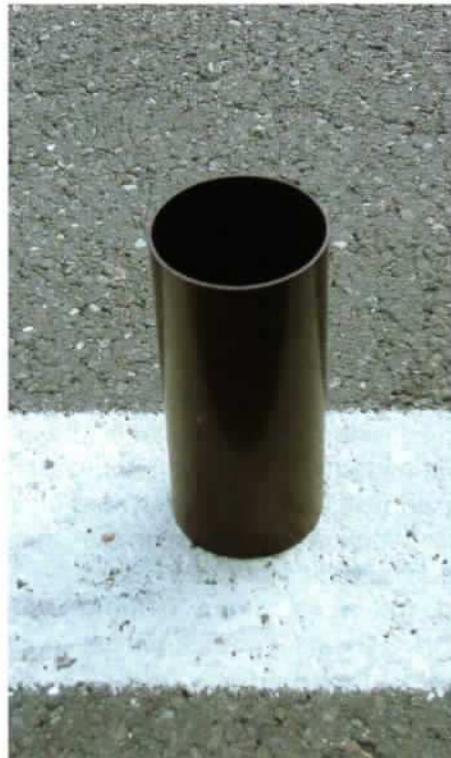
Durch ein einfaches Plastikrohr als Hilfsmittel kann man sehr gut die Verteilung der Nachstreumittel überprüfen.
