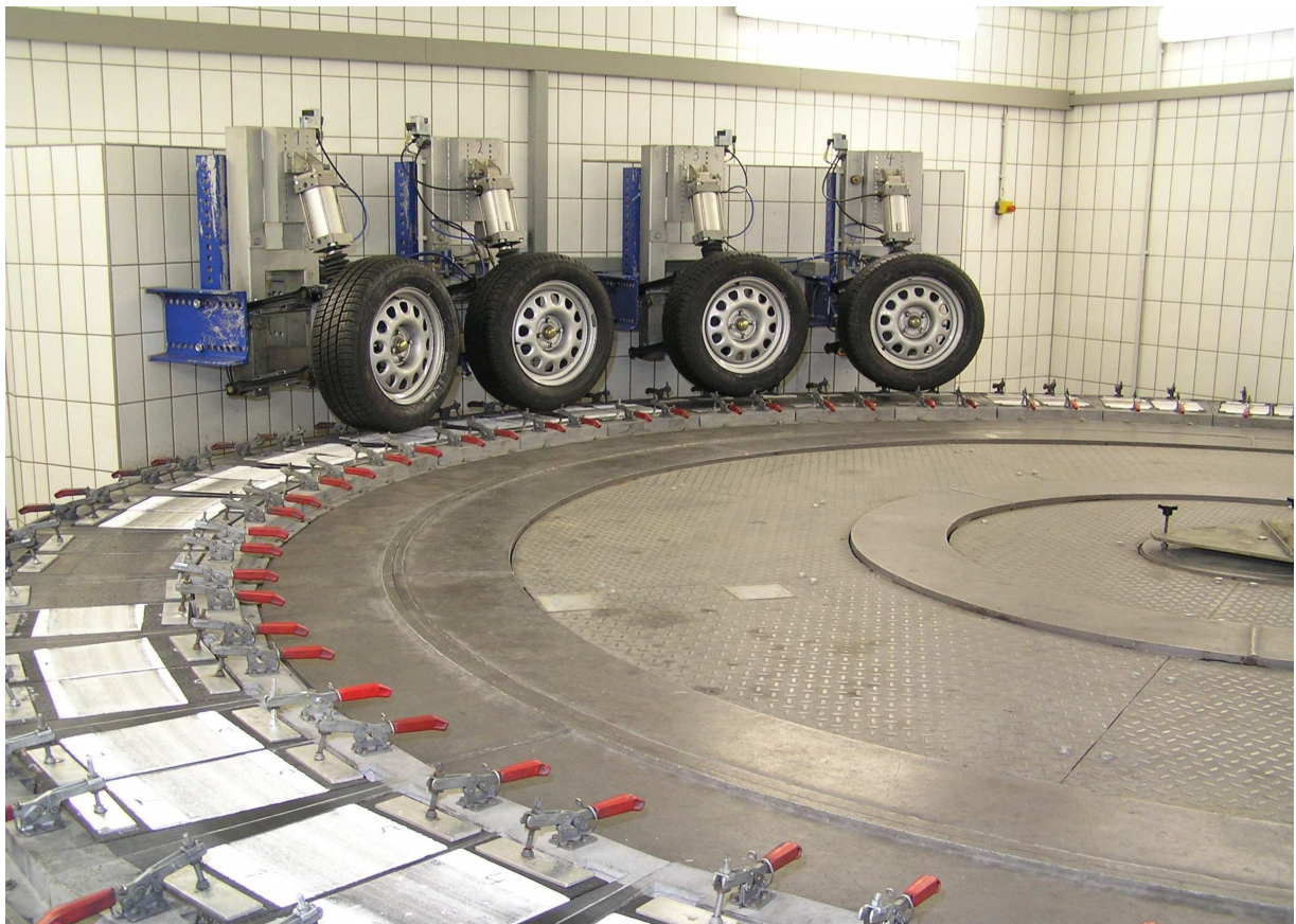
Abbildung 1: Innenraum der Rundlaufprüfanlage der BAST
